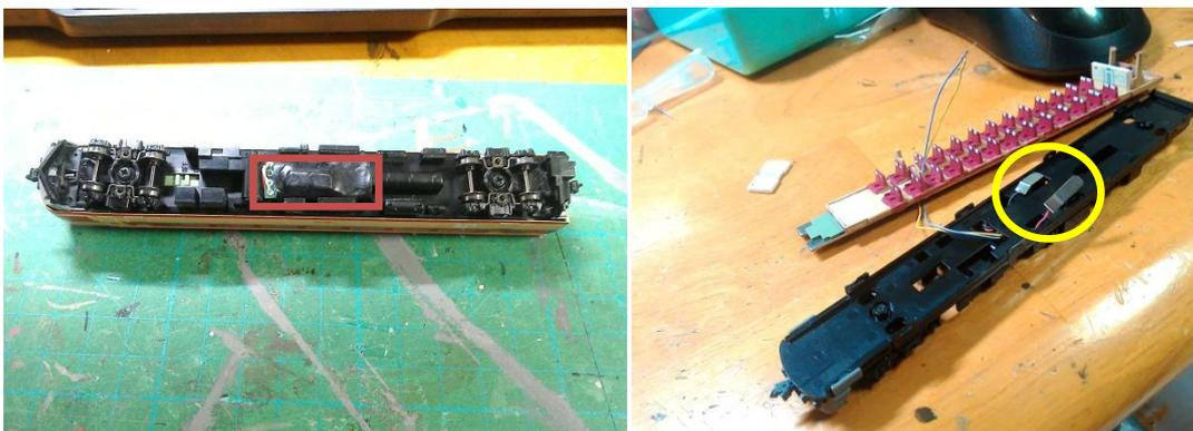
床下機器の内側を薄刃のこぎりやハンドドリル用いて床下にデコーダを入れるスペースを赤枠内に作成します。床下の色に合わせて熱収縮チューブを全体に巻いています。配線を逃がす穴も必要に応じて空けます。
