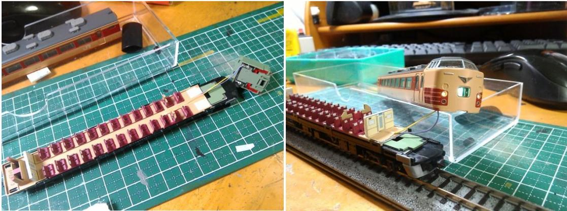
ワンコインデコーダ（モータ用）の CV 値を設定することで両極性タイプの FL デコーダにすることができるので、ライト用基板の改造は最低限で済みます。室内の配線を目立たなくさせるために、床の色に塗ったマスキングテープを配線の固定を兼ねて行いました。
