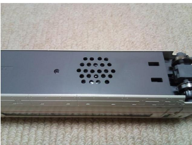
スピーカは床下に穴を開けると共に当たる箇所を一部削り、ゴム系接着剤にて固定。
