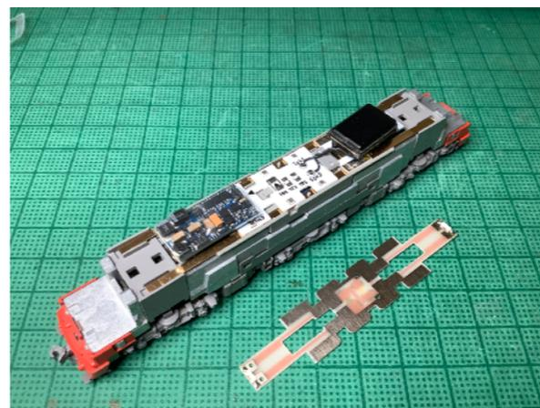
Loksound5は外側を向くようにつけます。中央部はラジエーター部で屋根裏の隙間が少ないため開けてください。
