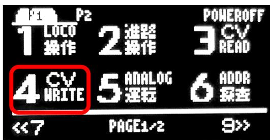
CV 番号と、CV 値を入力してください。最初に CV 番号を入力し、ENTER を押すと CV 値の設定が可能です。CV 値を設定して ENTER ボタンを押すと、DCC 信号を出力し、DCC デコーダに CV を書きだします。
