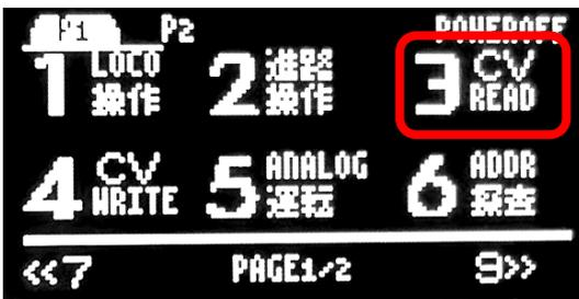
次に、3 ボタンを押します。所望の CV 番号を指定してください。クリアしたい場合には FNC ボタンを押すと CV 番号の入力結果がクリアされて入力し直すことができます。
