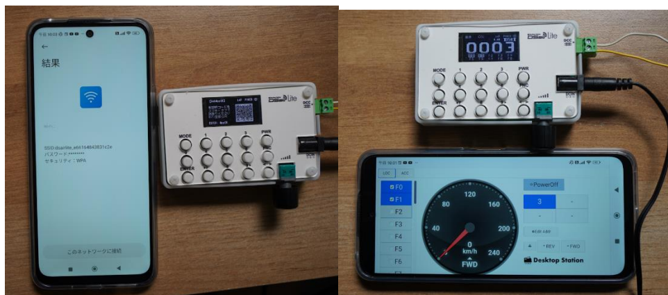
図 3.2.1 Web アプリで DSairLite に接続した状況
