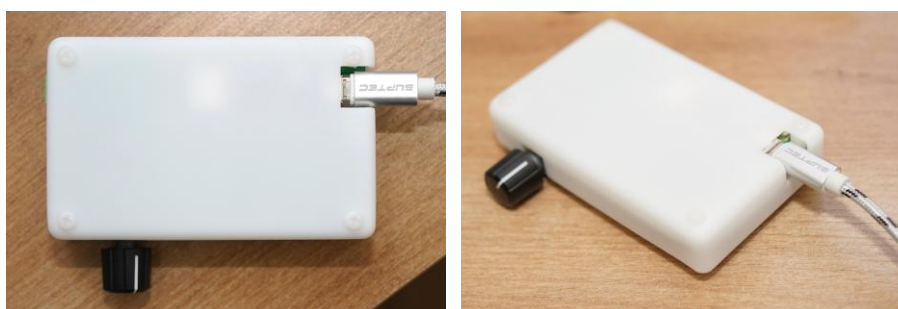
図 3.1.3 USB 接続の例（ケースに穴あけをした場合）
