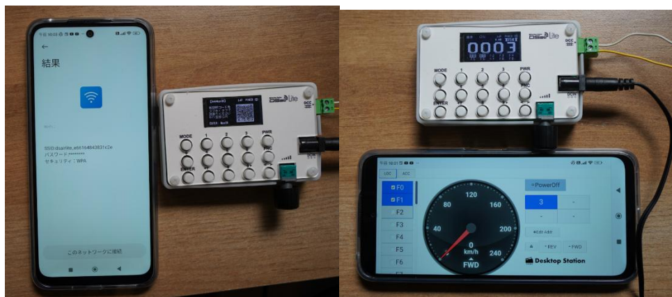
図 3.2.1 Web アプリで DSairLite に接続した状況
