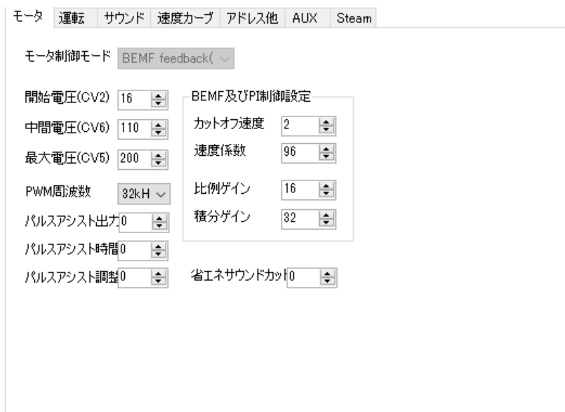
図 9.2.1 モータ CV 設定画面
