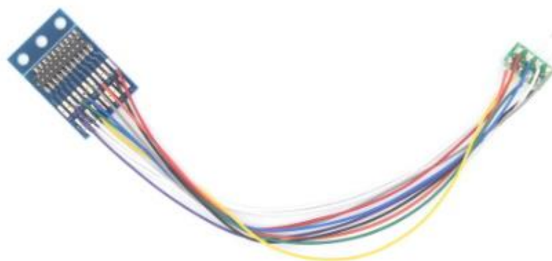
図 5.4.6.1 Lais860046 MTC21・NEM652 変換ケーブル
