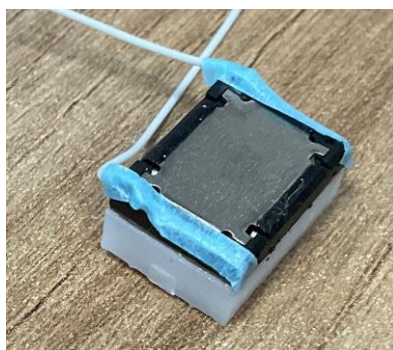
図 5.9.3 マスキングテープで絶縁対策したスピーカー
