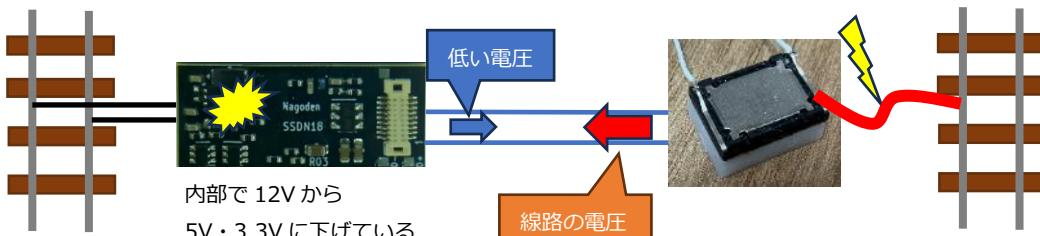
図 5.9.2 デコーダが故障するメカニズム
