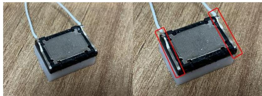
図 5.9.1 キューブスピーカーの導電部
