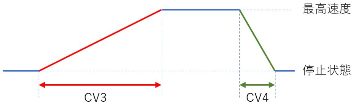
図 9.5.2 加速時間(CV3)・減速時間(CV4)の定義
