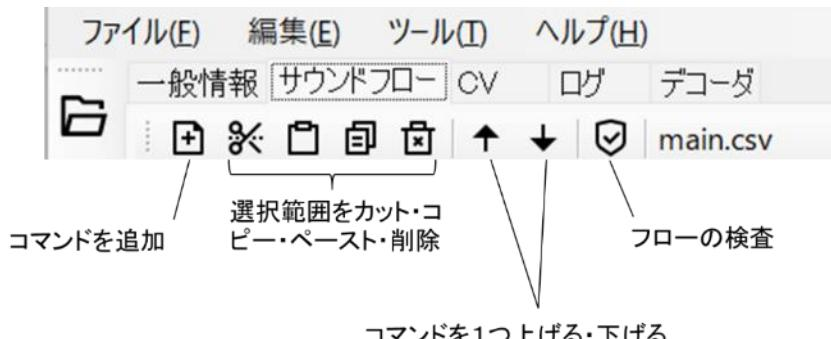
図 8.3.2 サウンドフローエディタの編集ツールボックス
