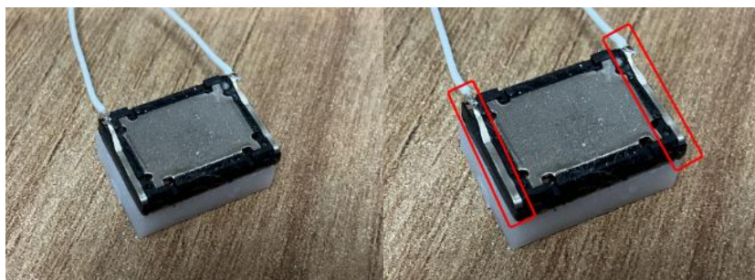
図 5.10.1 キューブスピーカーの導電部
