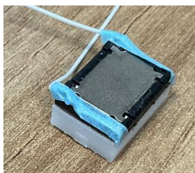
図 5.10.3 マスキングテープで絶縁対策したスピーカー
