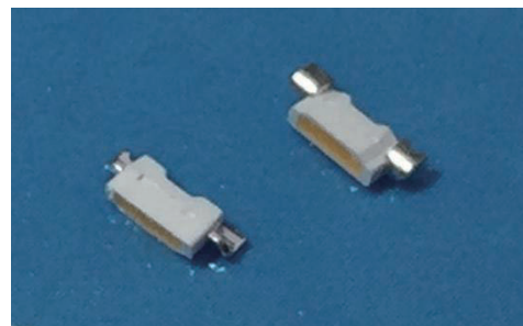
▲ SC4008WWHは4020サイズ(4x2mm)の電球色LED。電極が露出しており秋月電子取扱いの白色チップLEDよりもハンダ付けしやすい。
