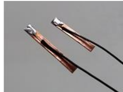
図:電線をはんだ付けしたところ
