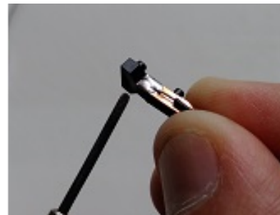
根元窪み部と銅箔テープ端部を合わせる
