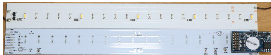
図 エンドウ純正室内灯とExpBoard YP試作版の比較
