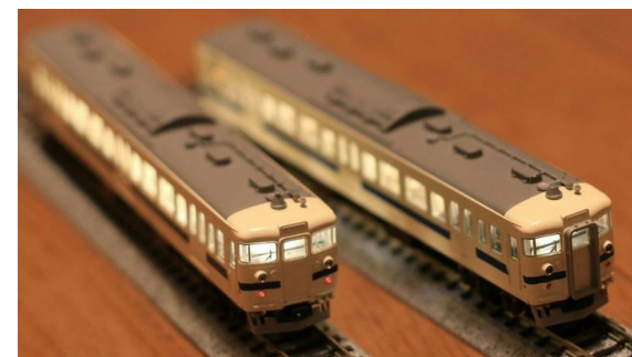
図5 LED化後の車両(左)と加工前の車両(右)
