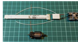
デコーダとモータとスピーカーとを並べて配線のイメージを掴む。
