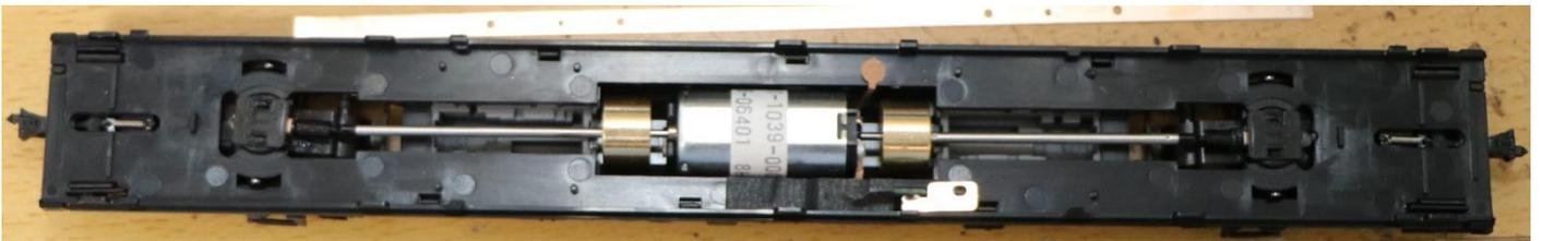
用电烙铁取下连接在电机上的铜板。
