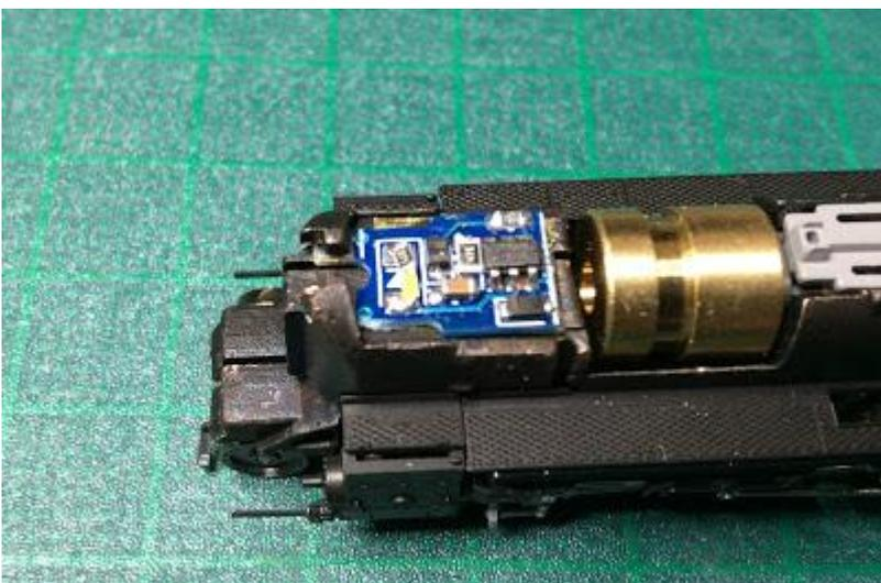
组装我做的零件。印制电路板和扬声器用少量的橡胶胶固定在一起。乐声板也是压铸的，用胶带绝缘，防止短路。
