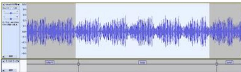
首先，我们将检查开始和循环之间的区域。观察声音的振幅最小的点，并将其放大。然后，我们找到下面的部分。调整这里的零交叉部分，移动它的位置，使它处于起始和循环标签之间的边界。你可以通过在圆圈上 D&D 来实现。
