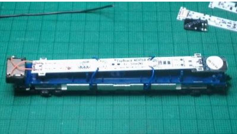
把板子装上，给 TLK1,2 MT1,2 接线。确保轨道侧和电机侧的接线正确。同时给扬声器接线。
