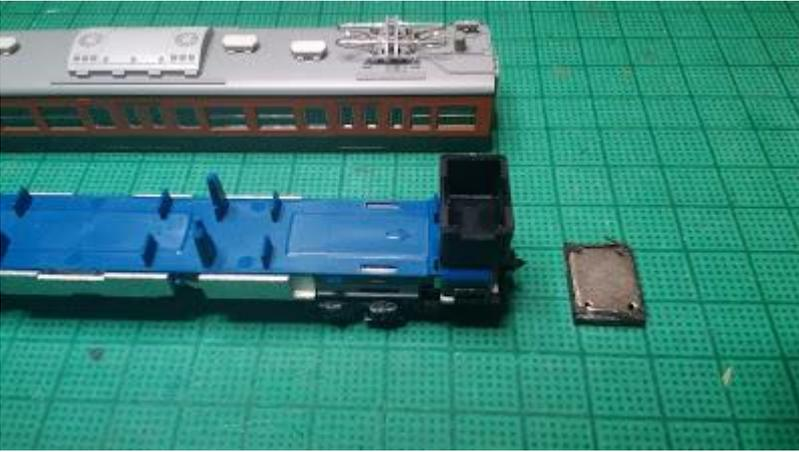
我还决定将扬声器安装在右侧。我将使用高知箱(SW-15B)和从阿里购买的扬声器。
