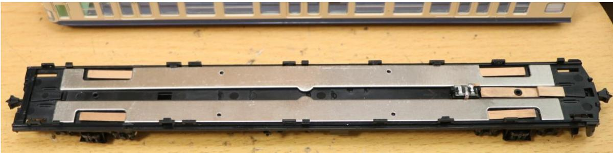
第一个 LED 是由这个开关分流的。由于它是由解码器控制的，所以我用烙铁把铜板拆掉，以避免与开关接线。
