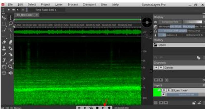
如果你看, 你会看到一些可疑的垂直条纹。本软件只允许你回放特定范围的内容。使用范围选择工具包围垂直条纹, 然后按播放按钮。你应该能够听到垂直条纹的声音。
