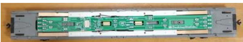
焊接磷铜铜板。如果弯曲过大, 就会打不牢下面的金属砵码, 造成接触不良。
