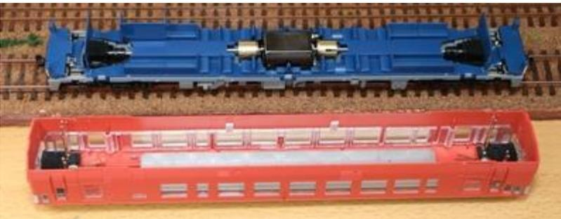
这款车是我第一次买的电车, 但它的底盘外侧有一块钢板作为重量。得益于此, 地板下的零件只用了塑料件, 所以在车内搭建很方便。反而牺牲了刚性, ...
