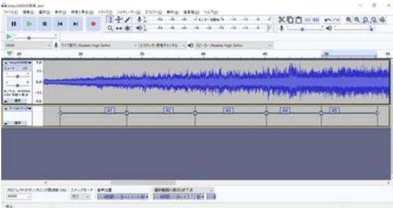
诀窍是在零交叉点(值为零)的块之间进行切割。这是因为在非零交叉点处切割可能会导致喃喃自语的声音。这一点编辑一定会消除喃喃自语的声音。另外,如果可以进一步调整,最好在 VVVF 分音符的零交叉点处进行切割。
