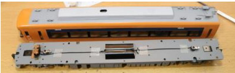
将焊接好的电路板安装在天花板上，并检查其位置。
