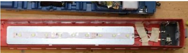
我试着点亮了它。由于是 DCC 车型,车内灯与车头灯、车尾灯可以分开开启和关闭,所以使用起来非常方便。似乎避免了火车被送进车库后,车灯还一直发光的笨操作。
