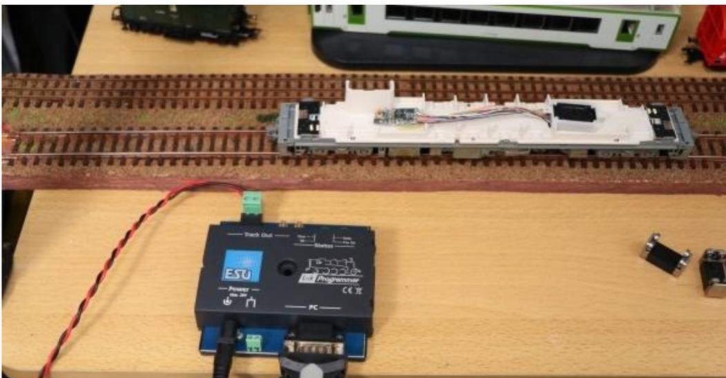
通过 USB 电缆连接的 LokProgrammer 写入器需要安装 FTDI 的 USB 串行驱动程序。通常情况下，USB 电缆插入后，驱动程序会自动安装，不需要特殊操作，但在某些环境下可能不会自动安装。
