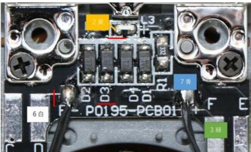
在这里，我们没有增加两个灯光解码器，如常见的 FL12 或一币解码器 FL，而是通过切割图案和在电路板上增加线路来处理这个问题，这样 ESU LokSound 的引脚就可以照样使用。这需要在车内进行复杂的布线工作，而且是针对高级用户的，所以如果你认为会有困难，最好使用 FL 解码器。
