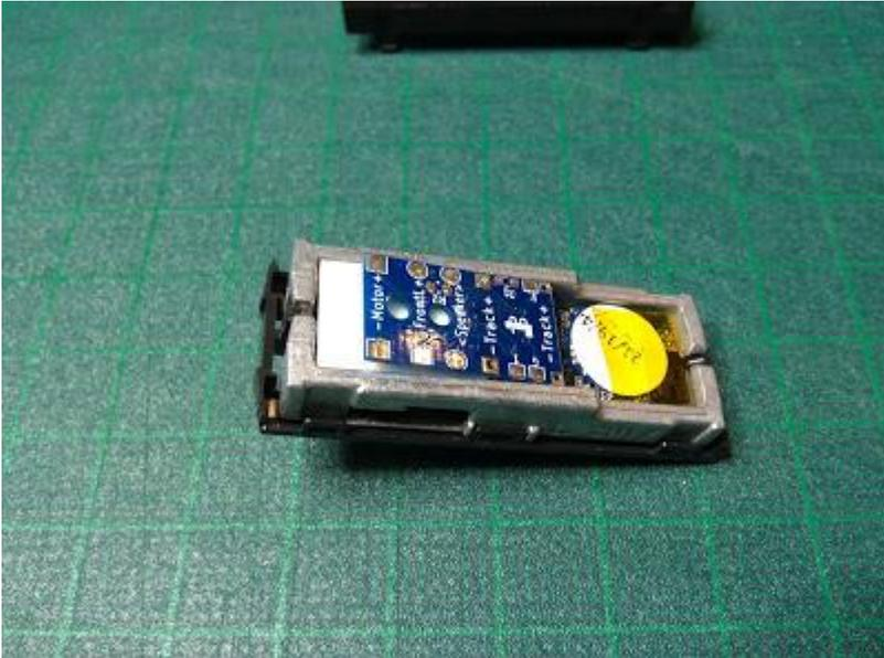
从 ExpBoard 上取出电机和扬声器的电线。这次，我从底面取出了所有的电线。将 0.2mm 的白线压在左右两边的砝码上，就可以从导轨上供电了。
