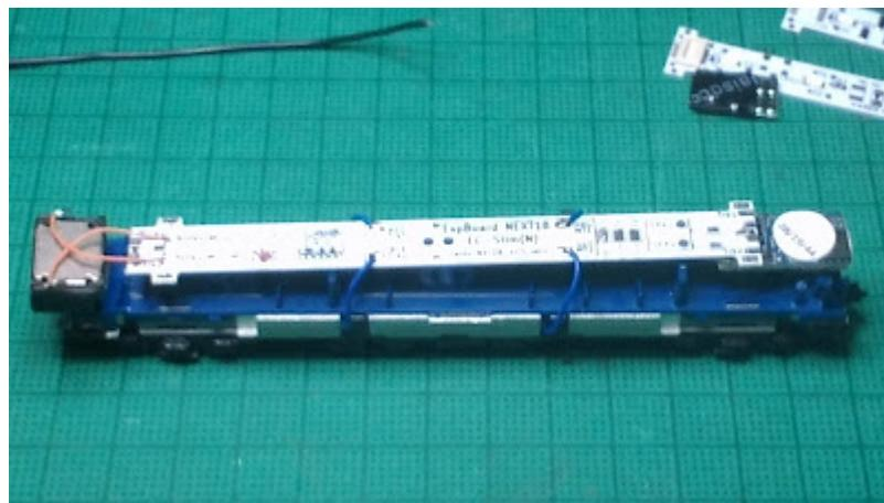
基板を載せてTLK1,2 MT1,2を配線します。レール側とモーター側の配線が間違いないことを再確認してください。さらにスピーカーにも配線します。
