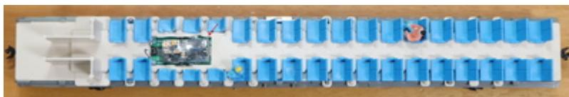
スピーカーの音を下に抜かすための穴をピンバイスで開けます。
