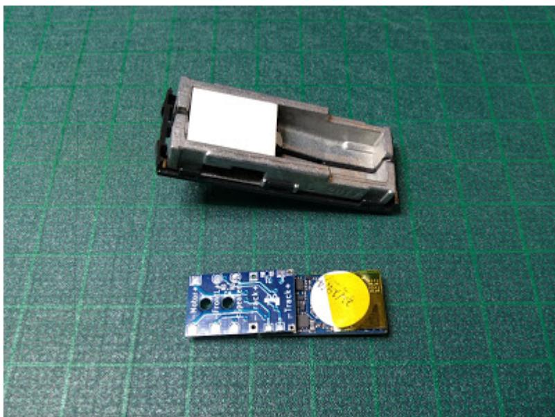
それぞれのパーツをウエイトの中に納まるか確認します。特に、プリント基板がウエイトより上部に飛び出すときは、スピーカーの当たっているところをわずかに削ります。
