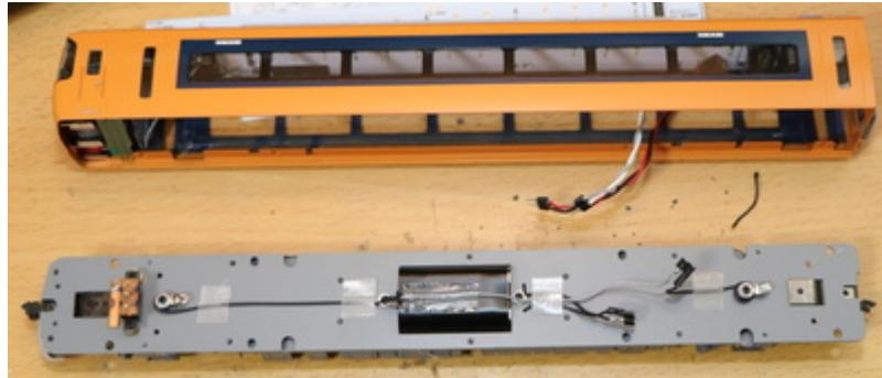
両極性機能の動作チェック。ExpBoard YPは、両極性基板の機能を搭載しているので、通常DCCで使用されるオープンコレクタ出力ではなく、両極性出力を使えます。という事は、アナログ車両のヘッドライト・テールライトのユニットは通常、両極性専用なので、日本型車両に搭載がしやすくなるわけです。
