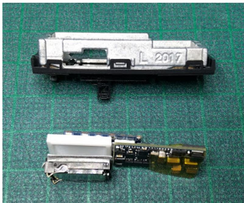
さて加工を始めます。C59のテンダーは長いのですがこの部分にRがついていてスピーカーの角と当たるのでリューターで少し彫り込みます。
