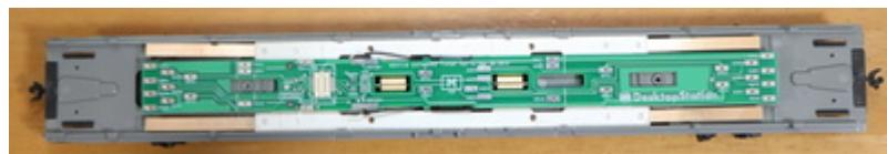
リン青銅の銅板を半田付けします。変に曲げすぎると、しっかりと下の金属ウェイトに当たらず、接触不良の原因となるので、写真と同じように半田付けします。
