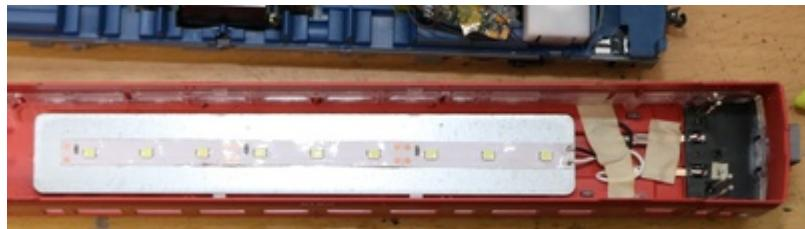
光らせてみました。計算通り、微妙に光っていますが、模型の室内灯としては結構良い感じと思います。DCCなので、ヘッドライト・テールライトとは別に、室内灯をファンクションでちゃんとON/OFFできるので、使い勝手も良い感じです。車庫への回送なのに光り続ける間抜けな運用は避けられそうです。
