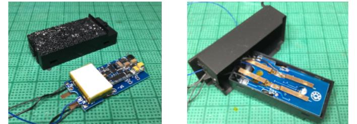
参考：KATO製SL（リニューアル品）のテンダーは、MRC製デコーダ・スピーカーに合わせた設計ですので、アルミダイキャストウエイトの切削加工などが必要です。
