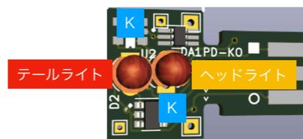
（プリント基板シルク印刷のKの向きに合わせる）
