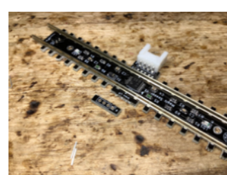
⑥ 不要部をカットし、裏面に絶縁テープを貼る。
