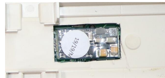
床をカットしてデコーダの搭載場所を確保した例
