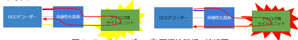
図8 ファンクションデコーダと両極性化基板の接続図
